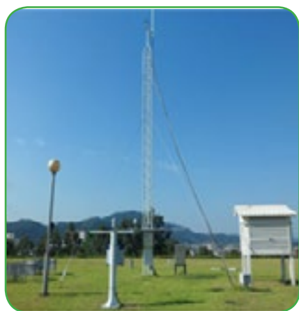
〈그림 3〉 자동기상관측장비 (AWS: Automatic Weather System) 및 설치 지역
