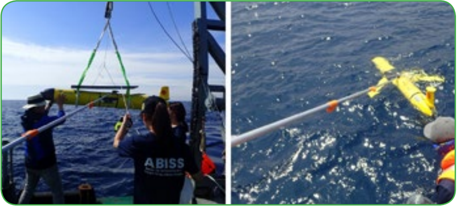
〈그림 20〉 수중글라이더 투하 · 회수 모습
